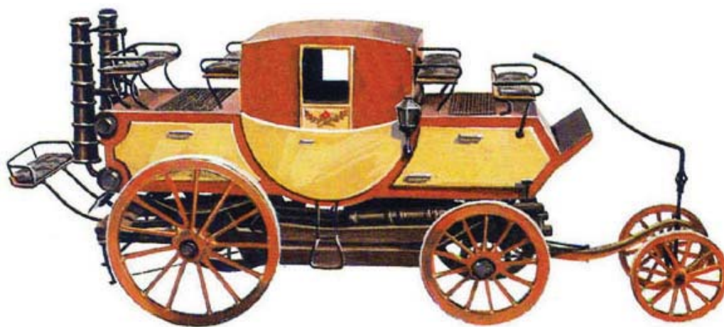
Рис. 1.9. Паровая карета. Великобритания 14 (1828 г.)
